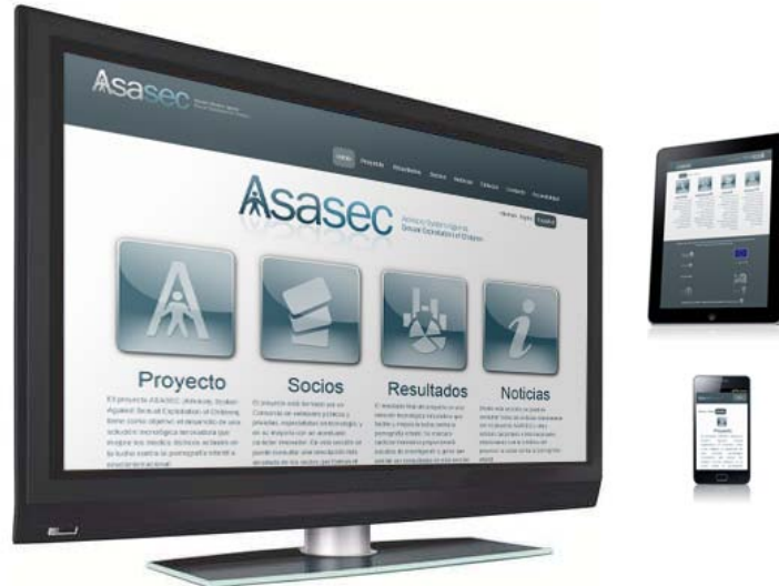
Figura 1. Asasec.eu: Ejemplo de Web con maquetación sensible (utilizando el estándar CSS Media Queries) adaptable a cualquier tipo de dispositivo.
